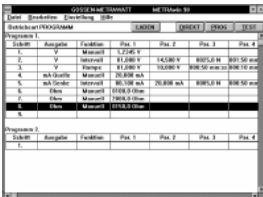
Zusammenstellung eines Prüfprogramms
